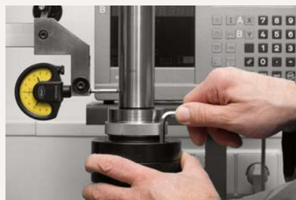
7. Ajuste la concentricidad con los tornillos de ajuste. De nuevo, vuelva a aflojar los tornillos de ajuste después de cada accionamiento. Repita esta operación hasta que el error de concentricidad sea < 3 µm.
