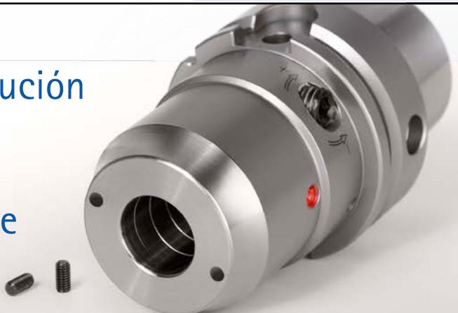
El HTC de MAPAL en ejecución pesada corta tiene una gran rigidez, alta transmisión del par y resiste grandes cargas térmicas de hasta 170 grados, como las que se dan, por ejemplo, en las fresas HPC. La rigidez a la flexión es 1,4 veces mayor que la de un portaherramientas térmico normal. MAPAL ofrece también el HTC en ejecución pesada corta con canales de refrigeración internos que pueden volver
