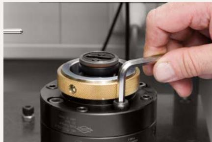
2. Inserte la brida antepuesta. Apretar los tornillos de fijación.
