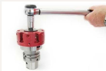
4. Ajustar la llave dinamométrica al par de apriete de 7 Nm. Apretar el tornillo de apriete de la fresa hasta el tope por medio de la llave dinamométrica. Montar la herramienta según la información del fabricante o utilizando el tornillo de apriete de la fresa según DIN 6367.
