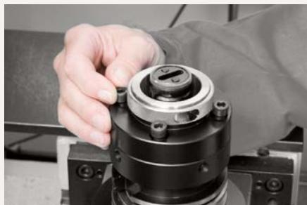
2. Inserte la brida antepuesta. Apriete los tornillos de fijación al 50% del par especificado (véase la tabla).
