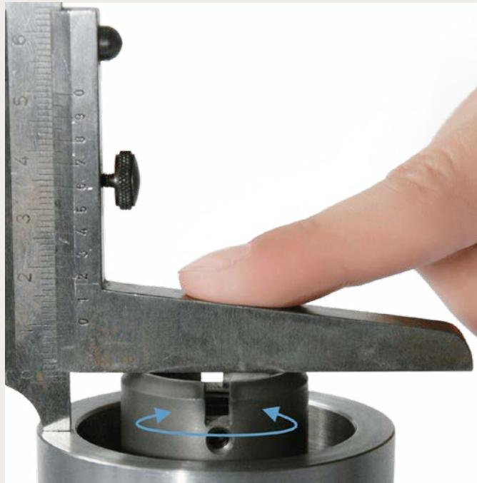
1. Atornille el tubo de tracción hasta el tope apretando con una llave Allen en sentido antihorario.
