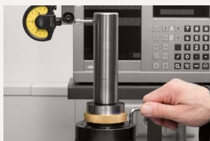
5. Para realizar la regulación angular, el reloj comparador debe colocarse en el punto de control superior o separado aprox. 100 mm del punto de separación. Realice la regulación angular con los tornillos de alineación. No afloje los tornillos de alineación después del accionamiento.
