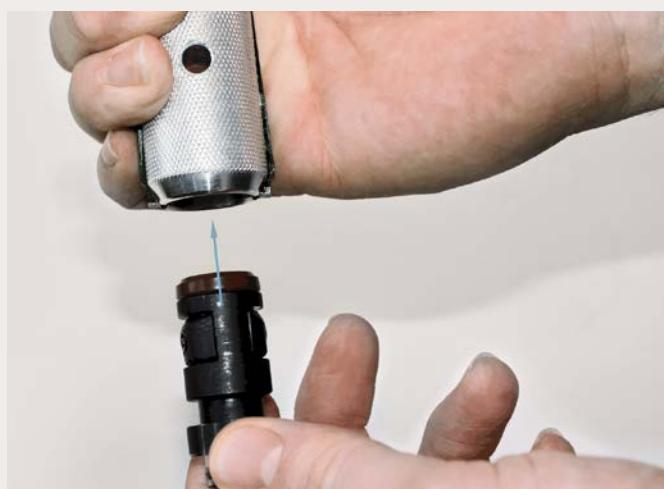
Colocar el cartucho de sujeción KS en la pinza de montaje KS
