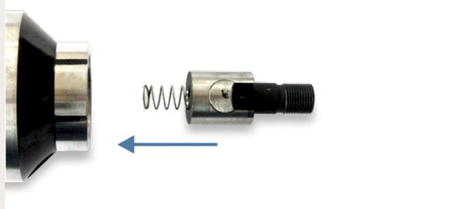
Introducción del tubo de tracción y del resorte de compresión
