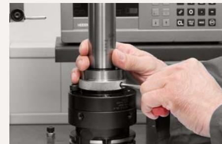
4. Coloque el patrón de verificación o la herramienta y fíjelo con el tornillo de sujeción.
