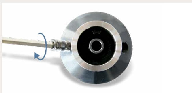
Atornillado del tornillo de apoyo en el contorno de conexión del husillo de la máquina
