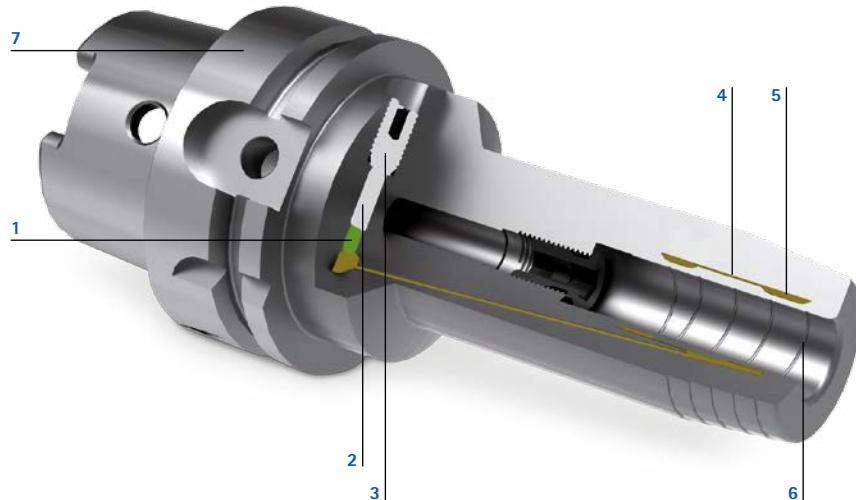
La tecnología hidráulica de sujeción por dilatación consiste en un tornillo de sujeción y un pistón de sujeción situados dentro de un sistema de cámara cerrada que generan una presión uniforme. El casquillo de dilatación integrado se encarga de transferir esta presión a la herramienta.
