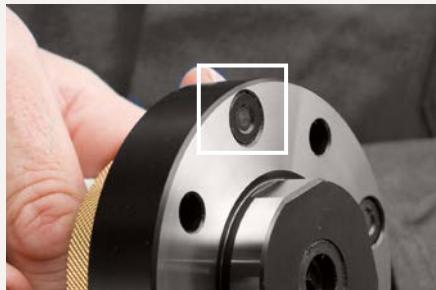
1. Limpie los planos de la brida antepuesta y el adaptador. Preste atención a que el plano del tornillo de alineación no sobresalga por encima del plano de la brida antepuesta.
