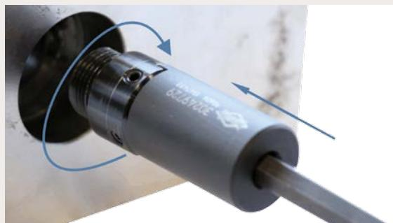
Atornillar el zócalo con el útil auxiliar de montaje
