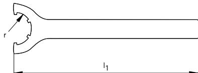
**Llave de sujeción para portaherramientas de sujeción para pinzas según DIN 69882-6 y portapinzas roscador Softsynchro**
