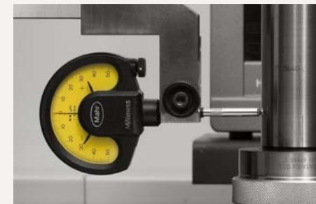
5. Coloque el reloj comparador en el punto de control de la concentricidad. En las herramientas MAPAL también se puede alinear en el collar HSK. Registre el punto de medición más alto y ponga el reloj comparador "a cero".
