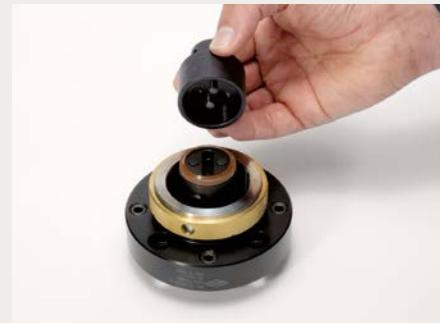
2. Coloque la llave de vaso en el cartucho de sujeción.
