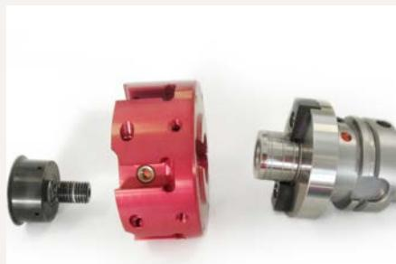
1. Limpiar con un paño la zona del alojamiento de la herramienta y del mandril hidráulico de sujeción por dilatación.
