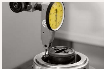
La alineación radial también se puede realizar con palpadores de medición. Para ello debe colocarse el palpador en el cono de la brida antepuesta.
