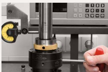
4. Coloque el reloj comparador en el punto de control de la concentricidad. En las herramientas MAPAL también se puede alinear en el collar HSK. Registre el punto de medición más bajo y ponga el reloj comparador "a cero". Realice la alineación radial.
