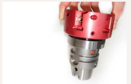
2. Colocar la herramienta, con el orificio y el apoyo plano delante, sobre el apoyo plano del mandril hidráulico de sujeción por dilatación.
