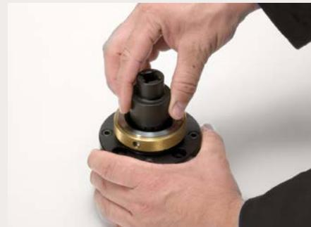
3. Gire en sentido horario hasta que el talón del cartucho de sujeción se enclave en el pasador de sujeción.
