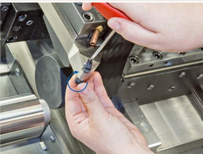
El giro específico de la plaqueta de corte reversible se realiza en la máquina. Primero debe soltarse ligeramente la plaqueta de sujeción con una llave Allen, tras lo cual el husillo puede girarse a la siguiente posición de trabajo. Una vez que se ha vuelto a apretar la plaqueta de sujeción con la llave Allen, el sistema de herramientas vuelve a estar listo para usarse.
