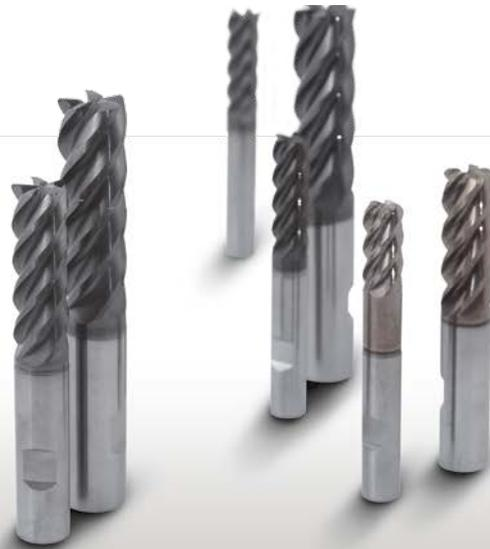
Para el fresado trocoidal, MAPAL ha ampliado su programa OptiMill de metal duro con fresas de una longitud de corte de 3xD. Especialmente desarrolladas para el arranque de virutas trocoidal, estas fresas disponen de cinco filos con división irregular y geometría optimizadas. Estas características, junto con el equilibrado de la parte activa de corte a G2.5, proporcionan una reducción de las vibraciones y unas elevadas calidades superficiales.
