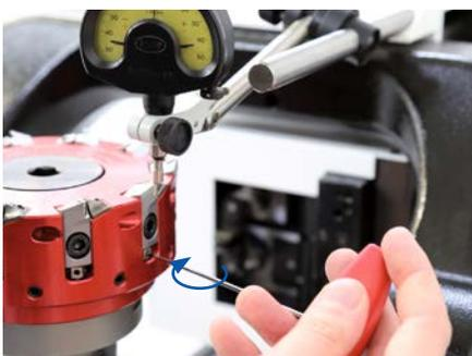
**10. Determinar ópticamente con el dispositivo de ajuste, o táctilmente con el reloj comparador, el cartucho de fresar con el filo de corte más alto y poner a cero. Seguidamente, ajustar todos los cartuchos de fresar ópticamente o mediante el reloj comparador con respecto al filo de corte más alto:**
