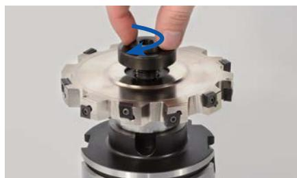
7. Enroscar el tornillo de apriete de la fresa en el portafresa ligeramente en sentido horario.
