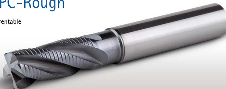
La fresa de desbaste de alto rendimiento OptiMill-Uni-HPC-Rough es un elemento destacado de la serie de fresas HPC de MAPAL. El novedoso perfil tipo cuerda garantiza una distribución óptima de las fuerzas de corte, y proporciona una mejor formación de la viruta. Mediante la división irregular de los filos se producen oscilaciones y vibraciones considerablemente menores. De este modo pueden realizarse velocidades de corte y avances
