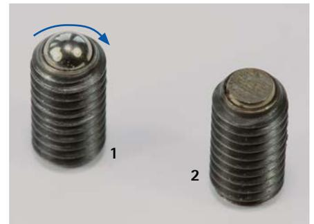
3. Comprobar si la cara plana del tornillo de seguridad (2) señala en dirección al asiento del cartucho de fresar. Si puede apreciarse una forma esférica (1) girarla con el dedo a la posición plana.
