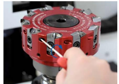
6. Enroscar el tornillo de seguridad hasta el tope con una llave dinamométrica en sentido horario, y, seguidamente, girar hacia atrás media vuelta.
