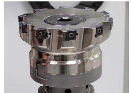
6. Girar la fresa hasta que la plaquita reversible para alisar se encuentre en la posición de medición. Seguidamente, desplazarse hasta el punto axial máximo de los filos.
