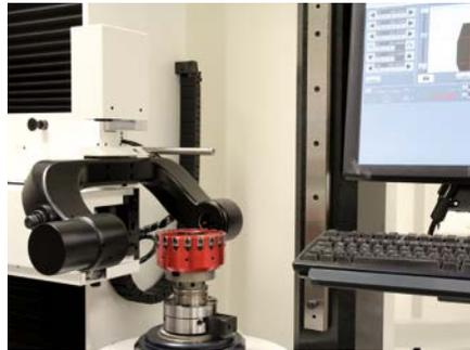
5. Ajustar ópticamente con el dispositivo de ajuste un cartucho de fresar  $-0,01$  mm antes de la medida de ajuste EM:
