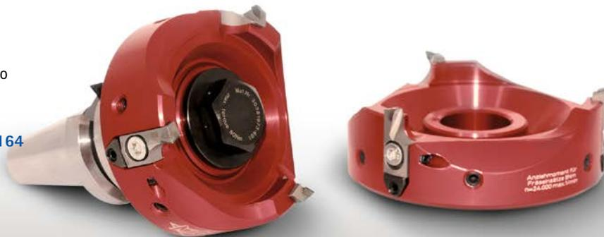
Para producir unas superficies lisas como un espejo de carcasas de aluminio, incluso en máquinas de mecanizado pequeñas, MAPAL ha desarrollado el innovador sistema FlyCutter ECO, una nueva dimensión en el planeado con fresa HSC. La FlyCutter es perfecta para el mecanizado de acabado a altas revoluciones y, al mismo tiempo, con un bajo peso máximo de la herramienta, por ejemplo, en husillos BT 30. Todos los diámetros de cabezales de fresado
