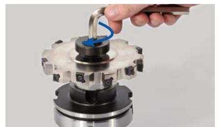
8. Seguir enroscando el tornillo de apriete de la fresa con una llave Allen en sentido horario y, a continuación, apretar con una llave dinamométrica (para el par de apriete, véase la tabla «Par de apriete para el tornillo de apriete de la fresa»).
