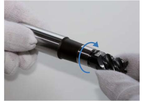
3. Enroscar manualmente el cabezal de fresado intercambiable en sentido horario en el portaherramientas para cabezal intercambiable. Seguidamente, sujetar el portaherramientas para cabezal intercambiable junto con la herramienta en el soporte de la máquina.
